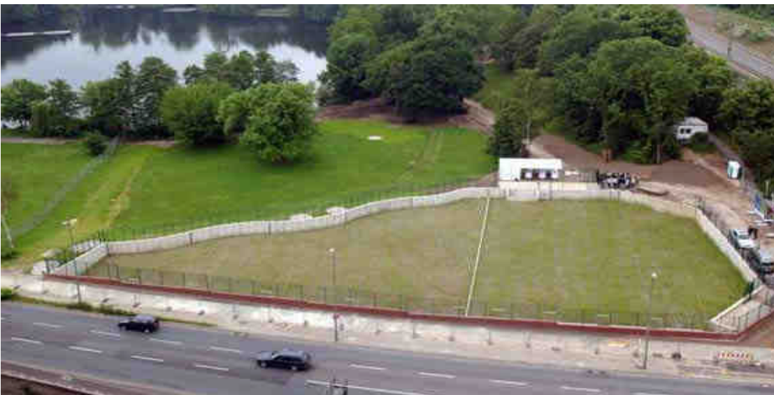
Abb. 13: Retentionsfilter im Schema und Abb. 14: Luftbild vom Retentionsfilter in Halensee,
